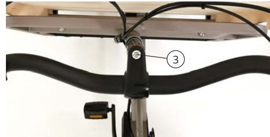
Einstellung des Lenkervorbaus
