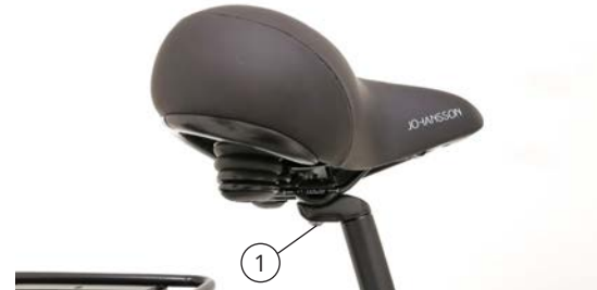
Einstellung der Sattelneigung
