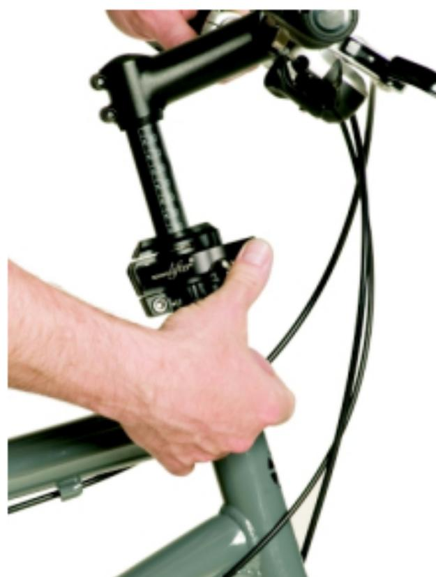
Der Speedlifter Schnellspannhebel muss während der Fahrt immer geschlossen sein! Beim Speedlifter Twist ist zusätzlich darauf zu achten, dass der Entriegelungsbolzen in der Bohrung vorne eingerastet ist. Prüfen Sie vor jeder Fahrt, ob der Schnellspannhebel vollständig geschlossen ist! Öffnen Sie den Hebel nie während der Fahrt! Halten Sie an, um die Lenkerhöhe einzustellen!
