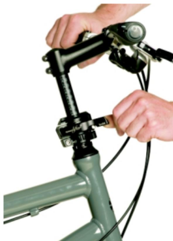
Öffnen Sie von Hand den Hebel des Speedlifters und bewegen Sie den Lenker in die gewünschte Position. Schließen Sie nun den Schnellspannhebel vollständig, damit der Lenker arretiert wird. Das war's schon. Fertig.
