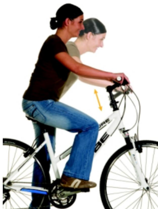
Mit dem Speedlifter können Sie mit wenigen Handgriffen ohne Werkzeug die Lenkerhöhe an Ihrem Fahrrad verändern. So wechseln Sie sekundenschnell zwischen einer aufrecht-entspannten und einer sportlichen Sitzposition. Mit dem Speedlifter Twist können Sie zusätzlich den Lenker wahlweise 90° nach rechts oder links drehen um Ihr Fahrrad platzsparend abzustellen bzw. zu transportieren.
