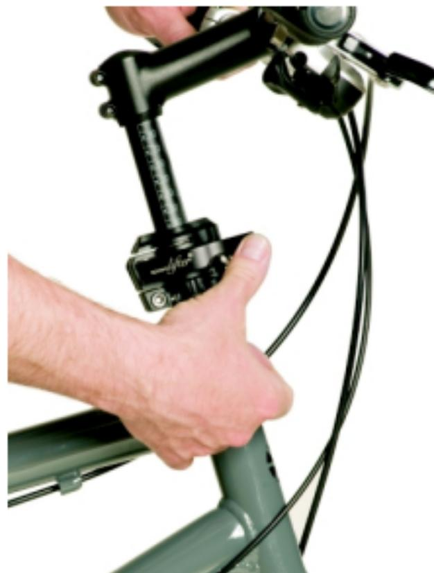
Pendant que vous roulez, la manette de serrage rapide du Speedlifter doit être impérativement en position fermée! Avec le Speedlifter Twist veiller à ce que le goujon de déverrouillage soit bien enclenché dans la forure. Avant chaque trajet, vérifiez que la manette est bien complètement bloquée! Ne jamais déverrouiller la manette de serrage rapide pendant l'utilisation du vélo. Arrêtez-vous pour faire cette opération! Risque d'accident!
