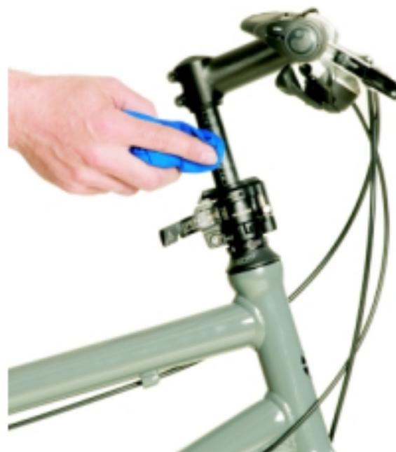
Die Speedlifter-Systeme sollten um die einwandfreie Funktion sicher zu stellen regelmäßig gewartet werden. Befreien Sie den Speedlifter von anhaftendem Schmutz. Benutzen Sie dafür ein sauberes feuchtes Tuch. Geben Sie bei Bedarf etwas Öl auf das Schaftröhr und auf den Drehpunkt des Schnellspannhebels.
