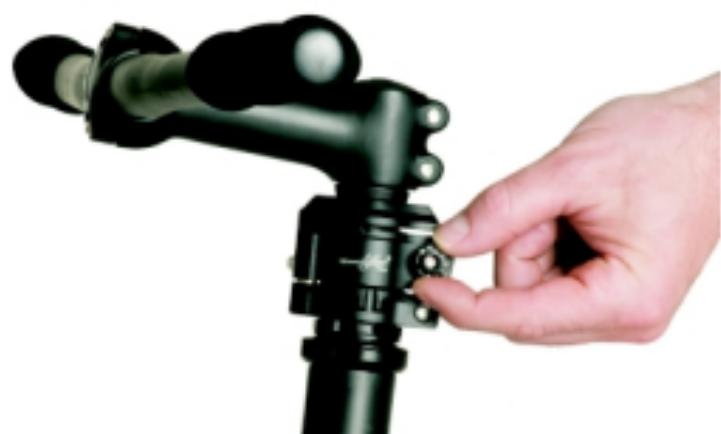
Öffnen Sie den Schnellspannhebel.
