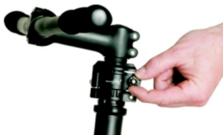
Ouvrez complètement la manette de serrage rapide. Tourner légèrement l'écrou moleté dans le sens des aiguilles d'une montre et reverrouiller complètement la manette de serrage rapide. Vérifiez la fermeté du guidon. Répétez l'opération si nécessaire jusqu'à ce qu'il ne bouge plus. Si vous ne pouvez plus fermer la manette complètement, desserrez légèrement l'écrou de réglage en le tournant un peu vers la gauche.
