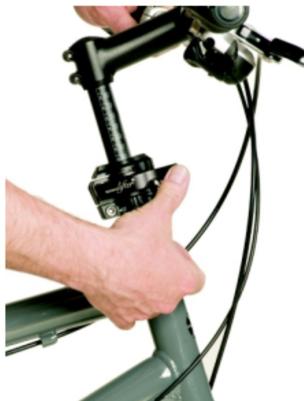
Tijdens het fietsen moet de Speedlifter hendel altijd volledig vergrendeld zijn. Check voor elke fietsrit of de hendel volledig vergrendeld is. Bij de Speedlifter Twist moet u er bovendien op letten dat de ontgrendelingsbout voorop zich volledig in de uitsparing bevindt. Ontgrendel de hendel nooit tijdens het fietsen. Stap af om de stuurhoogte te verstellen.
